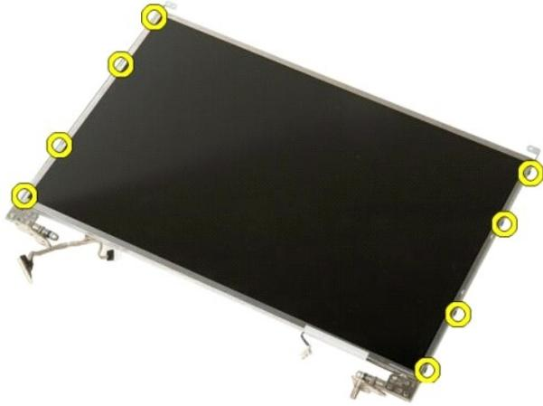
7. Separe las bisagras del ensamblaje del panel de la pantalla.
