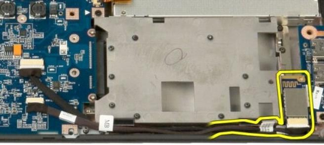
12. Desconecte el cable de datos del módulo Bluetooth.
