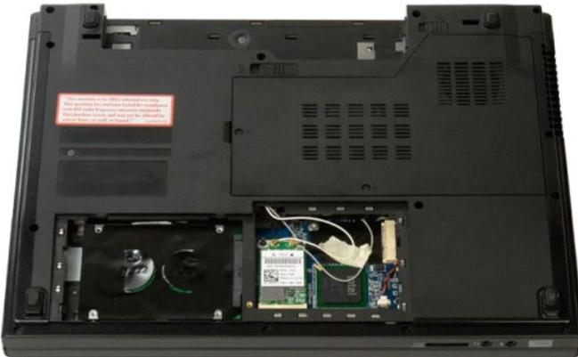
8. Desconecte los cables de antena de la tarjeta WLAN.
