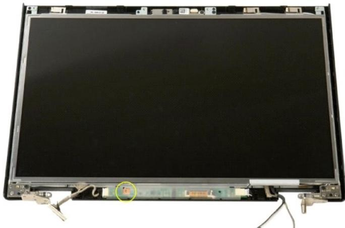
4. Abra el seguro para cable de datos del inversor de la pantalla.
