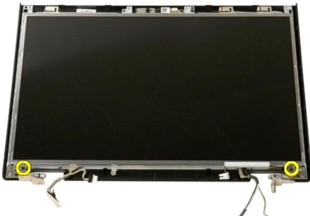
5. Extraiga el panel de la pantalla LCD del ensamblaje de la pantalla.
