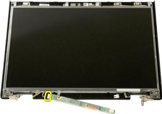
7. Extraiga el inversor de la pantalla del ensamblaje de la pantalla.
