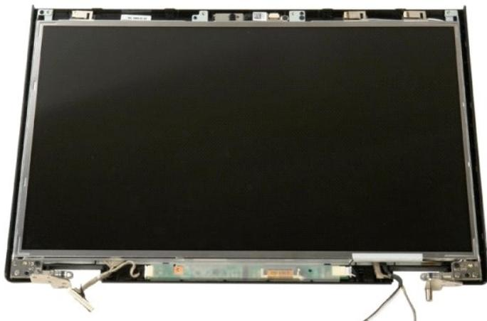
3. Quite el tornillo que fija el inversor de la pantalla al ensamblaje de la pantalla.
