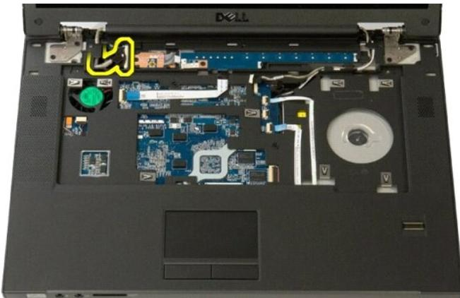
11. Separe con cuidado los cables de antena de la placa base.
