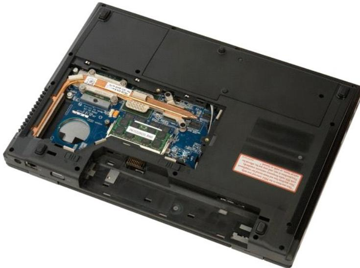
5. Afloje los seis tornillos cautivos que fijan el disipador de calor a la placa base.
