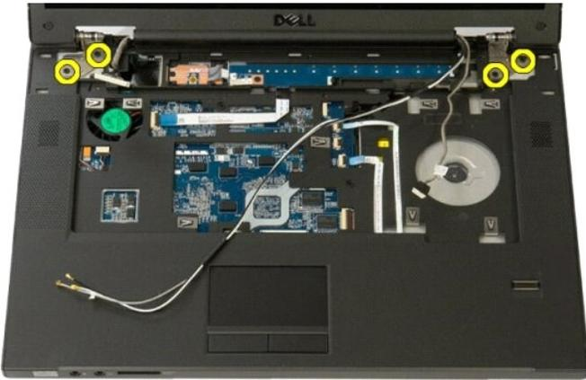
15. Levante y extraiga el ensamblaje de la pantalla de la base del ordenador.
