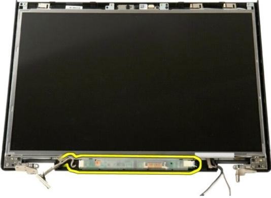
5. Retire el cable de datos del inversor de la pantalla del seguro para cable.
