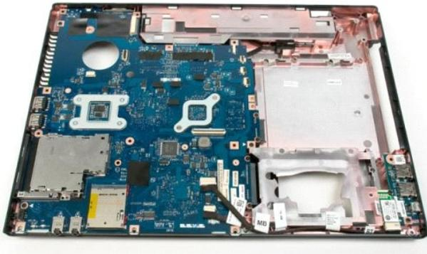
18. Desconecte el primer cable de datos de la placa base.
