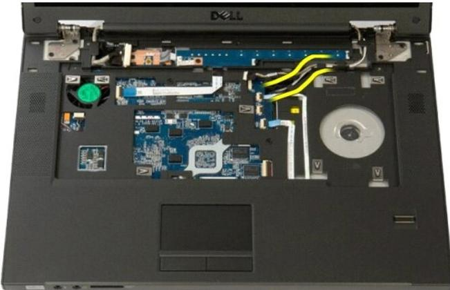
12. Retire los cables de antena de las ranuras del tendido de cables.
