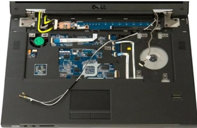
14. Quite los cuatro tornillos que fijan el ensamblaje de la pantalla a la base del ordenador.
