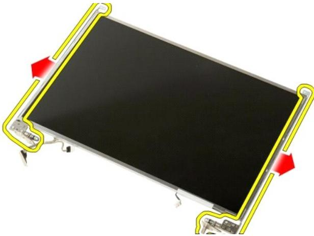
8. Extraiga las bisagras del panel de la pantalla del ensamblaje del panel de la pantalla.
