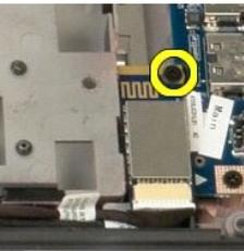
11. Levante el borde del módulo Bluetooth más cercano a la parte frontal del ordenador y levante el módulo para extraerlo de la ranura.
