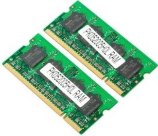
**📌 NOTA:** DIMM A es el módulo más cercano a la placa base. No puede extraer DIMM A hasta que haya extraído DIMM B. Si sólo hay un DIMM instalado, siempre debe estar instalado en la ranura DIMM A. Si sólo hay un DIMM instalado, el traslado de memoria de DIMM A a DIMM B deshabilitará la función AMT (si está habilitada).
