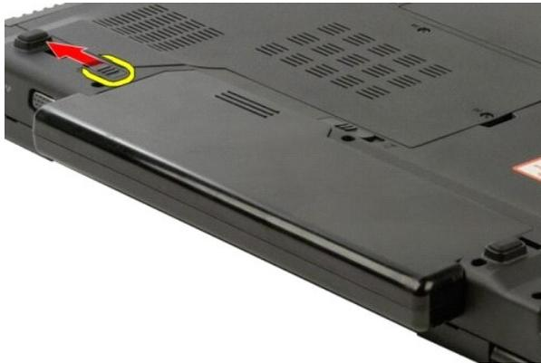
3. Deslice el pestillo de la batería de la parte central hacia la derecha.
