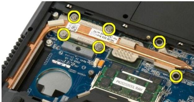
6. Levante el borde del disipador de calor más cercano al centro del ordenador.
