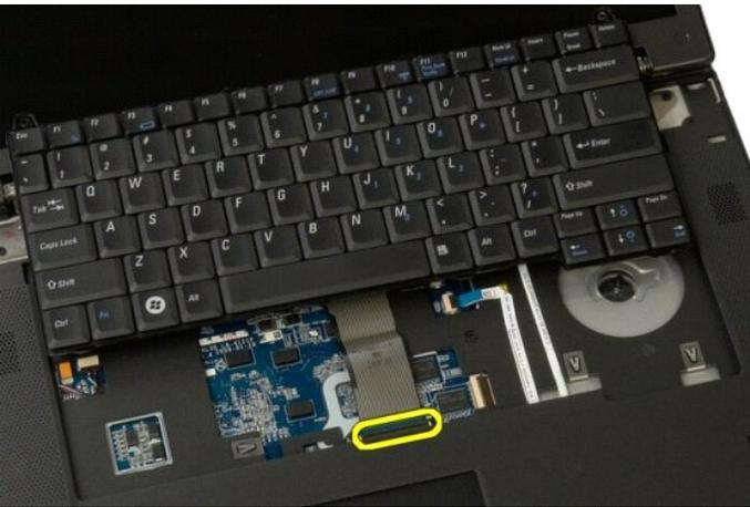
7. Retire el cable de datos del teclado del seguro para cable.
