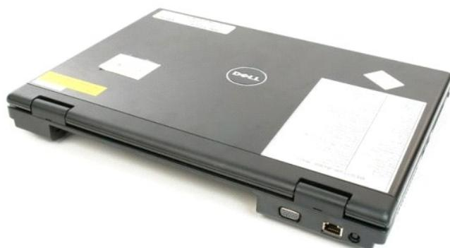
3. Utilice un instrumento de plástico acabado en punta para levantar con cuidado la parte posterior de la cubierta de las bisagras y separarla de la base del ordenador.
