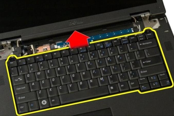
6. Abra el seguro para cable de datos del teclado para soltar el cable plano.
