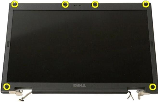
5. Extraiga el embellecedor del ensamblaje de la pantalla.
