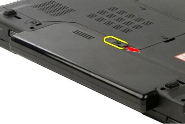
4. Deslice la batería hacia la parte posterior del ordenador y extráigala.
