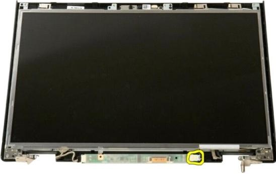
6. Desconecte el cable de datos del inversor de la pantalla.
