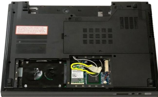
9. Desconecte el cable de la cámara de la placa base.
