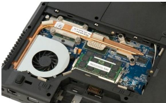
4. Desconecte el cable del ventilador de la placa base.
